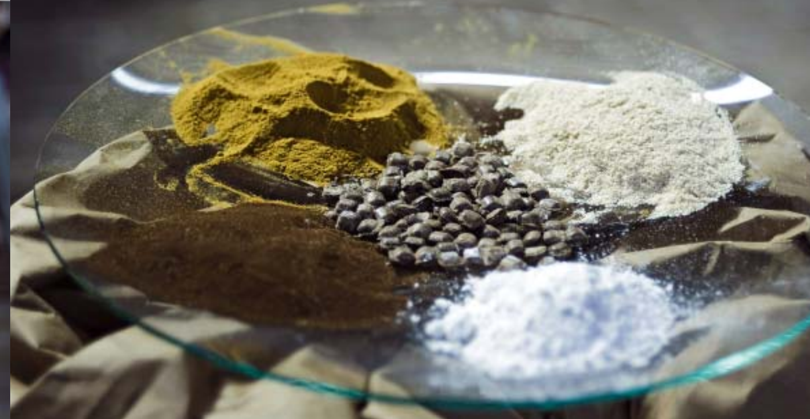
Das Arboform-Granulat (Bildmitte) und seine Ausgangsstoffe, Naturfasern und natürliche Additive wie Wachse und Harze.
